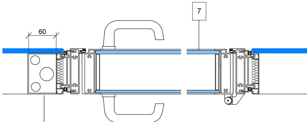
Canal de instalaciones para conductos de electricidad o datos
