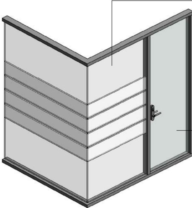
Suministro y colocación de mampara divisoria de vidrio a base de perfil extrusionado de aluminio con mecanismo de regulación, lacado color a elegir y vidrio laminado 6+6mm. Incluido todos los elementos necesarios para el soporte y fijación de la mampara a techo y suelo, junta elastómera para la atenuación acústica, sellados, forrados, tapetas y entregas con los diferentes elementos envolventes, así como todos los elementos necesarios para la correcta ejecución de la partida totalmente acabada.
