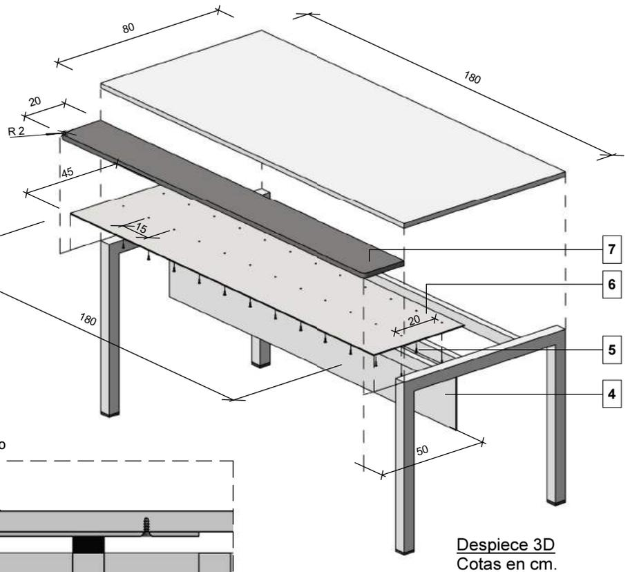
Tablero Compac Ice Zement encolado sobre chapa metálica con pegamento polimérico MS3 de Wurth o similar. Cantos pulidos.
