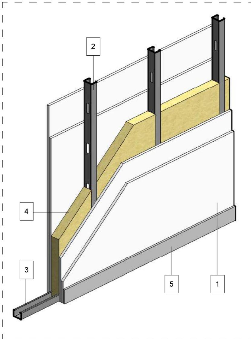
Tabique de placas de yeso laminado formado por estructura sencilla con perfilera de plancha de acero galvanizado, con un espesor total de 98 mm, montantes cada 400 mm de 48 mm de ancho y canales de 48 mm de ancho, 2 placas tipo estándar (A) en cada cara de 12,5 mm de espesor cada una, fijadas mecánicamente y aislamiento de placas de lana de roca semirígida de densidad  $\geq 70$  kg/m<sup>3</sup>
