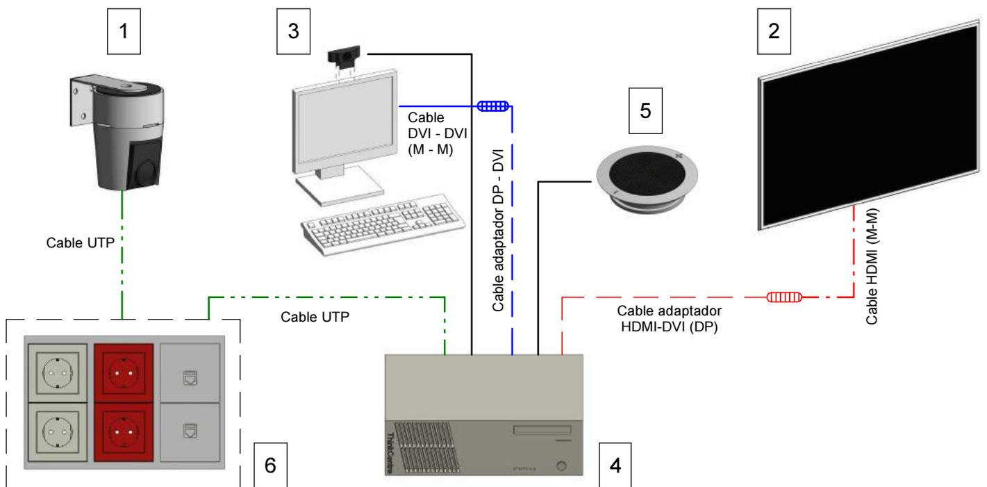
Esquema de principio - Instalación Telemedicina
