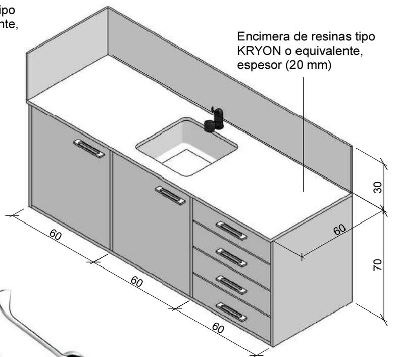
Pica de resinas tipo KRYON o equivalente sin junta visible
