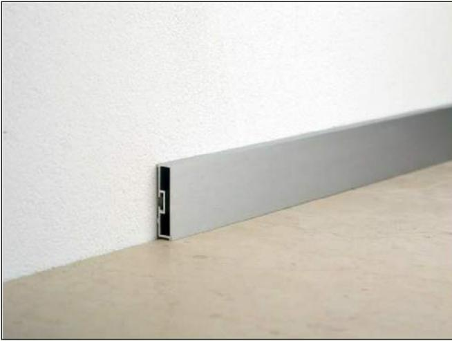
Zócalo de aluminio extrusionado color plateado mate, forma rectangular, de 70 mm de altura por 10 mm de anchura, de la casa Alumafel o equivalente, colocado con fijación encolada y con sellado perimetral superior.
