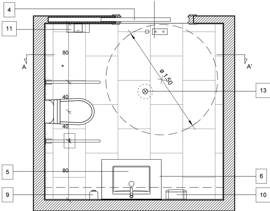
Aseo adaptado con doble transferencia - Planta
